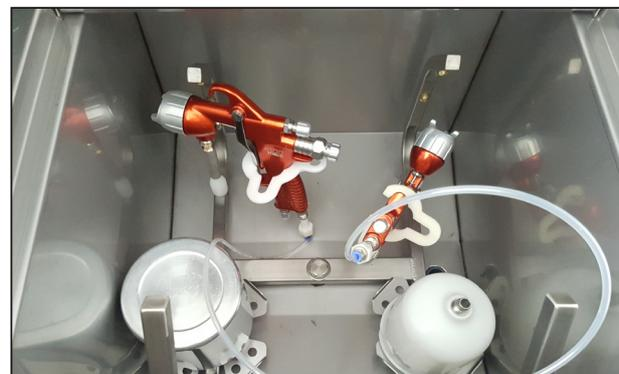
4. Coloque la pistola y sus componentes en el tanque de lavado de la lavadora, teniendo cuidado de insertar la pistola en la boquilla de limpieza.
