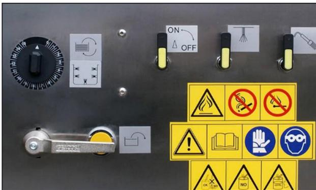
Coloque la válvula o palanca de intercambio de disolvente limpio-sucio en la posición de enjuague (horizontal) para disolvente limpio y pulse el botón de enjuague durante el tiempo deseado para esta operación. De esta manera las boquillas pulverizadoras de lavado rocían disolvente limpio en la bañera y las boquillas de soplado también suministrarán aire.
