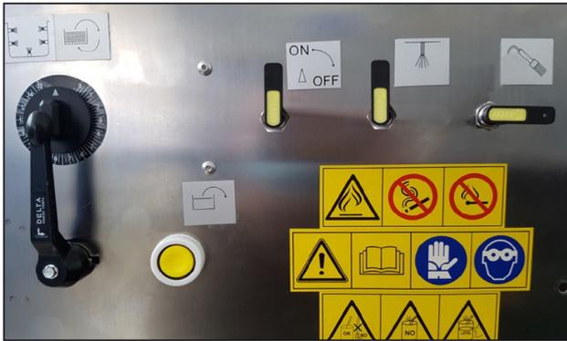
Ajuste el temporizador de lavado girando hacia la derecha, escogiendo el tiempo deseado. El disolvente aspirado desde el tanque de disolvente sucio o de recirculación, comenzará a salir por las boquillas pulverizadoras y las boquillas de limpieza para pistolas, para llevar a cabo el lavado de la pistola y sus componentes, mientras que las boquillas de soplado entregarán aire.
