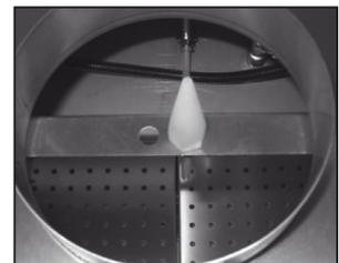
La aspiración se inicia automáticamente cuando la máquina se enciende con la válvula ON/OFF en el panel de control.
