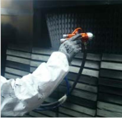
\*Équipement complet (chariot et sonde), inclut 4100 Xtreme 1.20 (XT01 B) et 5 m. de tuyaux d'air et produit (ø6mm. en intérieur).
