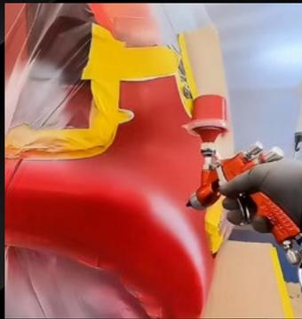
Spot Repair. Toute notre identité « Xtreme » en 365 grammes (0,80 lbs) : technologie métal sur métal, chapeaux d'air en duralumin, corps forgé et anodisé... Idéal pour peindre les pièces.
